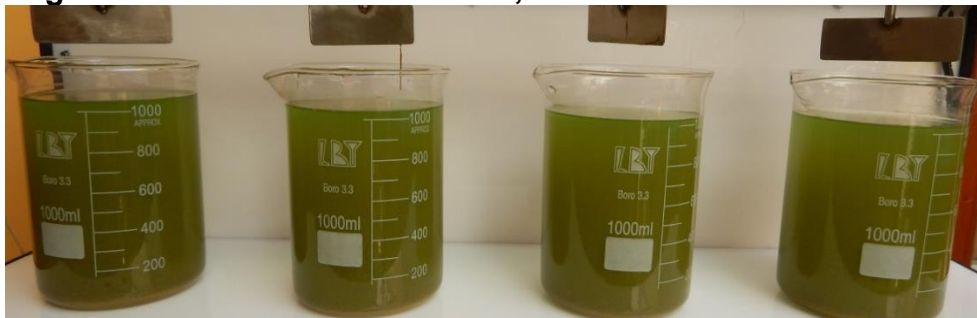
Figura 5.2.2. Efluente acidificado, a los 4 min de sedimentación
