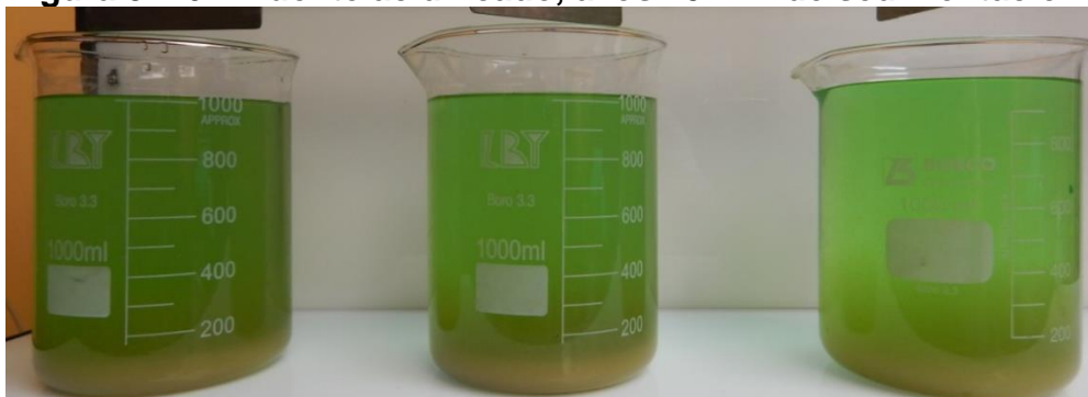
Figura 5.2.6. Efluente acidificado, a los 20 min de sedimentación
