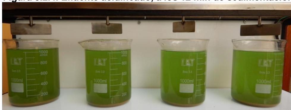
Figura 5.2.4. Efluente acidificado, a los 12 min de sedimentación
