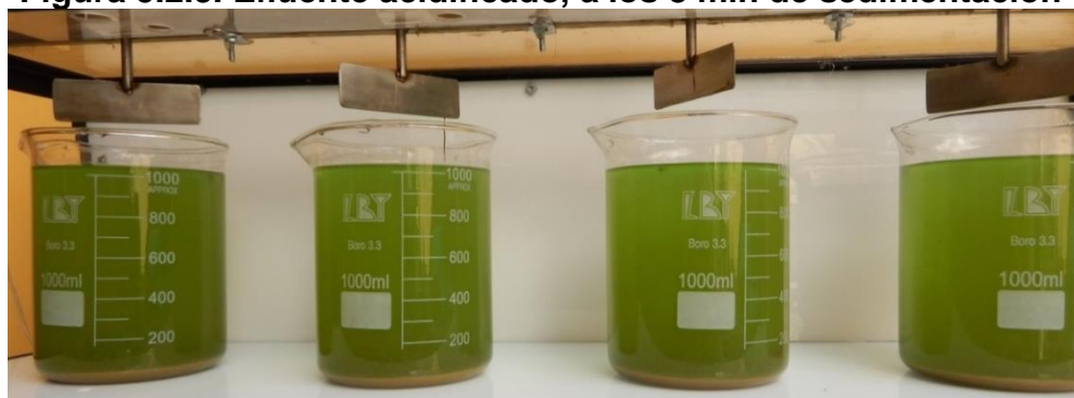
Figura 5.2.3. Efluente acidificado, a los 8 min de sedimentación
