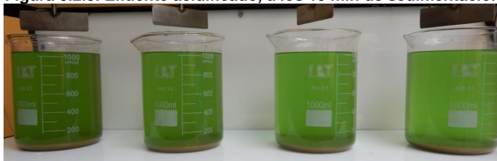
Figura 5.2.5. Efluente acidificado, a los 15 min de sedimentación
